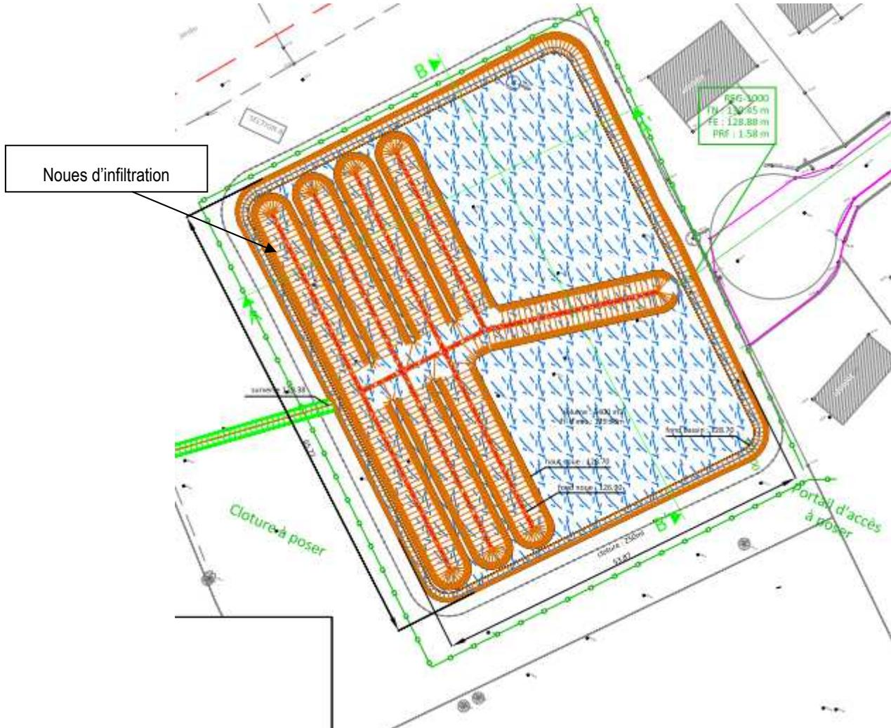
Figure 10 : Extrait du plan projet - Noues d'infiltration
