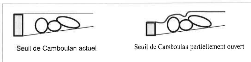
Figure 1 : Schéma de création de zones de rapides avec l'ouverture partielle du seuil de Camboulan
