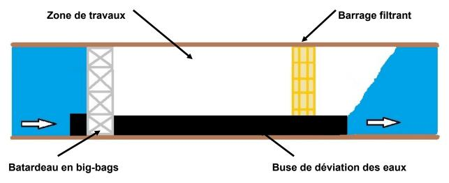
En cas de débit suffisamment faible, le batardeau et la buse de déviation des eaux ne sera pas forcément nécessaire. Le barrage filtrant, constitué par exemple d'un grillage positionné sur toute la largeur du cours d'eau et de bottes de paille déliées, devra néanmoins être prévu.
