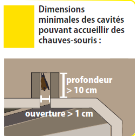
Gabarit minimal de fente à réaliser lors des travaux. (Source : CEN Occitanie - GCMP)
