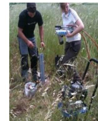
Test de résistance à l'arrachement des pieux
